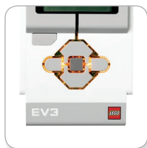
Индикатор состояния модуля – оранжевый
