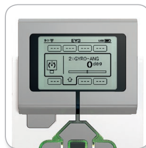
Представление порта с гироскопическим датчиком
