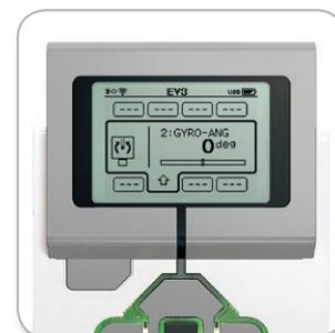
Visualização das Portas com o Sensor Giroscópio
