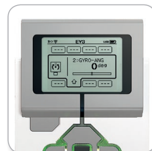
Poortweergave met Gyrosensor
