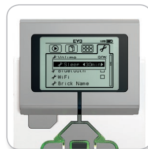
Regolazione del tempo di spegnimento automatico
