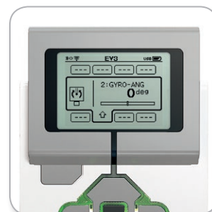
Affichage du port du capteur gyroscopique
