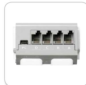
Conexión de motores
