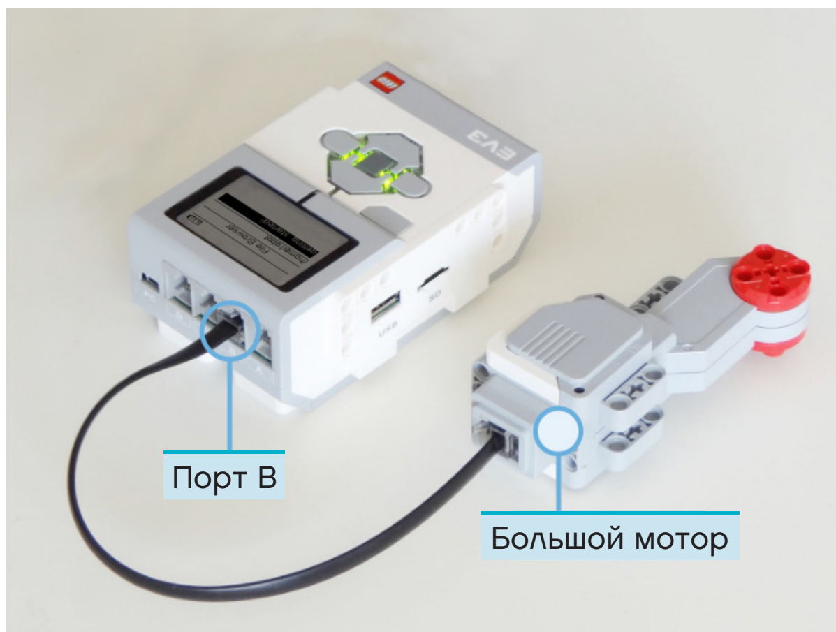
Рисунок 2.7. Микрокомпьютер EV3 с Большим мотором, подключённым к порту В.
