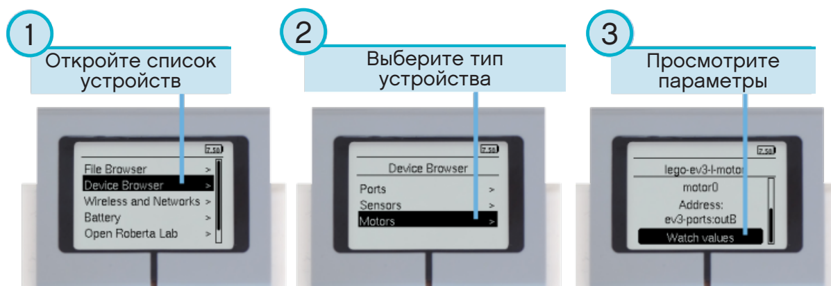
Рисунок 1.6. Просмотр параметров моторов и датчиков
