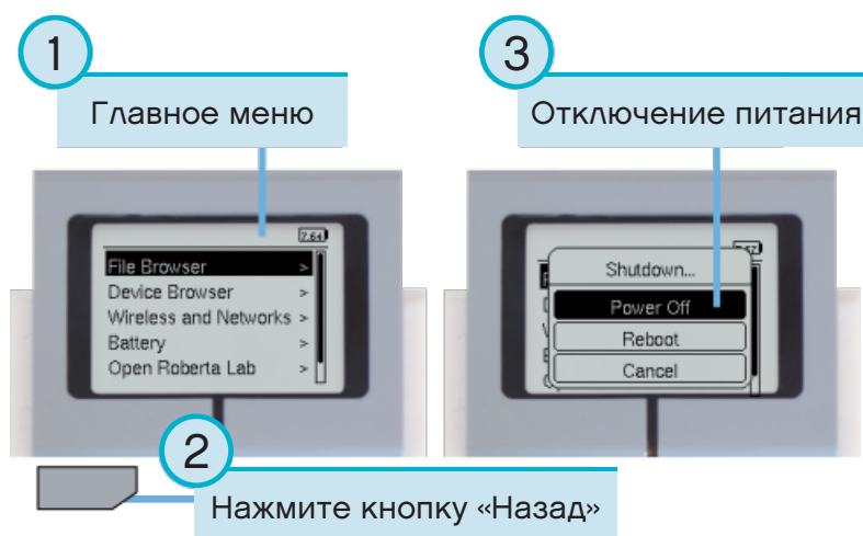
Рисунок 1.5. Выключение микрокомпьютера EV3
