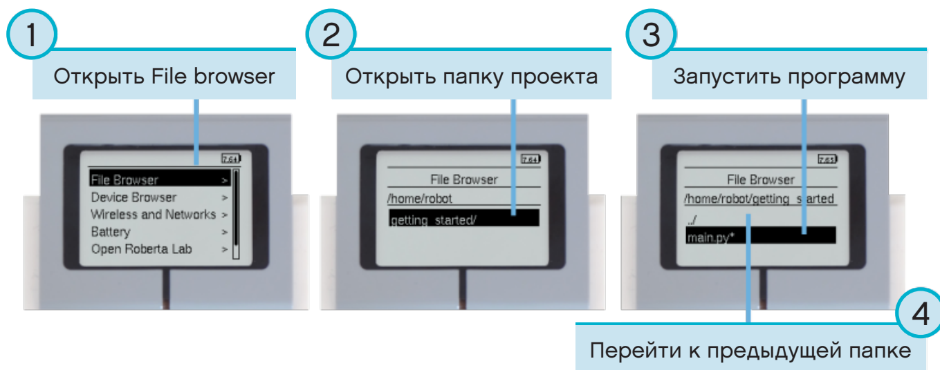
Рисунок 2.9. Запуск программы с помощью кнопок микрокомпьютера EV3
