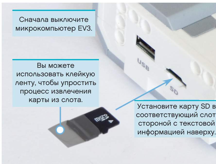
Рисунок 1.4. Установка карты microSD с записанным изображением в слот микрокомпьютера EV3
