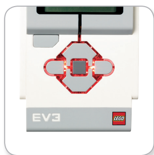
Индикатор состояния модуля – красный
