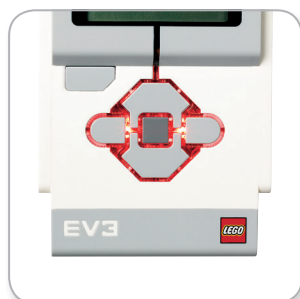
Luz de estado del Bloque EV3: Rojo
