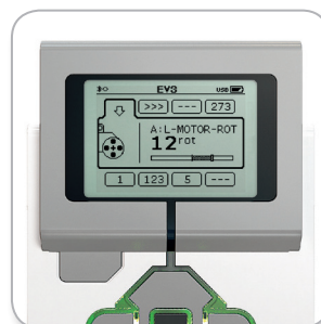
Aplicación de vista del puerto
