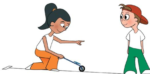
使用滚轮式测距仪更方便。滚轮式测距仪一次可以测量 3 m 的距离。但是必须读取两个刻度盘，以确保获得最高准确度。相比之下，使用标尺的话，需要不断移动标尺，然后在脑子里进行加法运算。而且每次移动标尺时，很可能出现错误。
