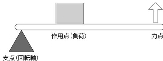
**第2種**てこは、それぞれ反対側の端に位置する力点と支点(回転軸)の間に作用点(負荷)があります。第2種てこの例として、くるみ割り器、一輪車、栓抜きが挙げられます。
