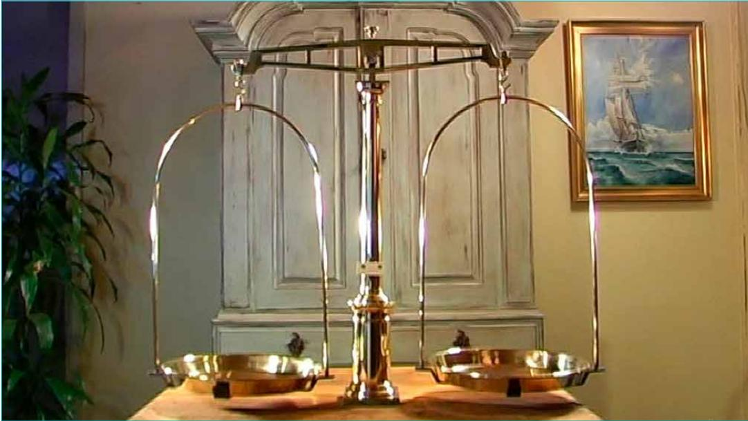
最简单的称重机是杠杆秤。天平的最初形式为一根中心有支点的杠杆。天平任意一端的重量发生变化都会改变杠杆的位置，并影响平衡。
