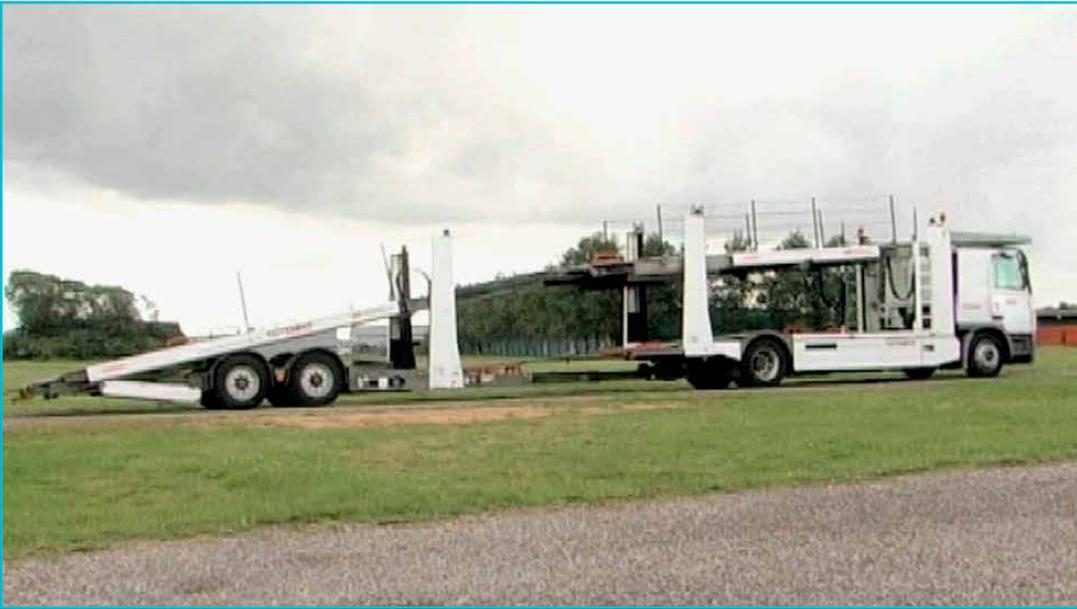
自古以来，人们就一直使用坡道将重物或大量材料从一个高度移至另一个高度。如今，汽车运输服务业在卡车上使用坡道，以便在一辆车上装载多辆汽车。坡道因其易用性、安全性和高效性而受到这种多车辆运输服务业的青睐。
