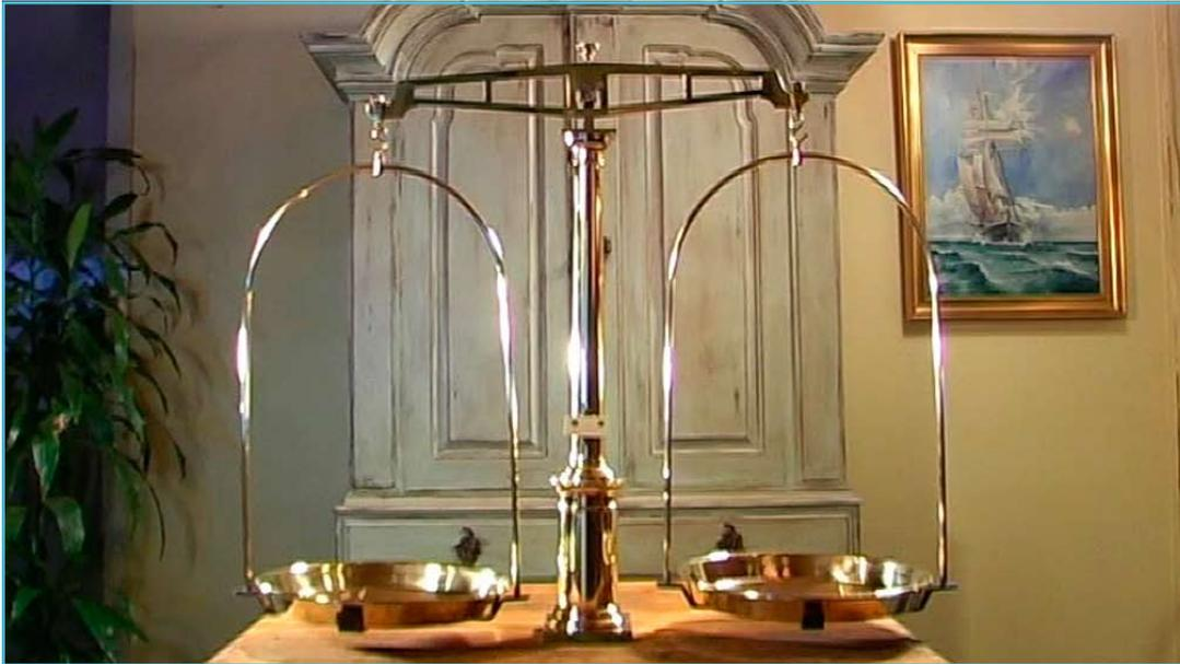
実験用てこ(竿秤)は、最もシンプルな計量器の一つといえます。実験用てこ(竿秤)は、1本のビームと中央の支点(回転軸)から構成されており、ビームの両端のいずれかの側の重量が変われば、バランスに影響が出ます。
