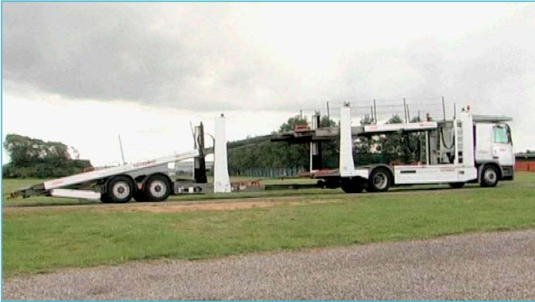
斜面(傾斜台)は昔から、重い物や大量の材料をある高さから別の高さまで動かすために使われてきました。現在では、自動車輸送のトラックで、複数の車を積み込むために斜面(傾斜台)が使われています。このように複数の自動車を輸送する際に斜面(傾斜台)を使えば、使い方も簡単で、安全で、効率も向上します。
