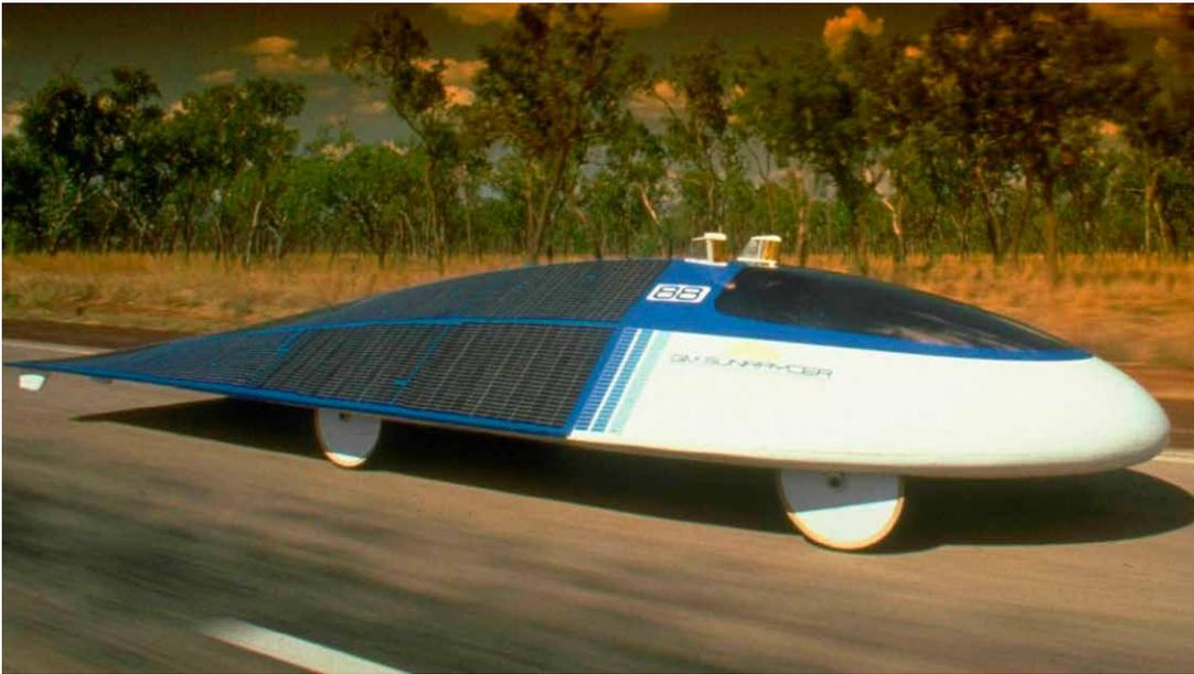
太阳能车借助太阳能电池板能将太阳能转换成电能。电机可以将电能转换为机械能，推动汽车行驶。
