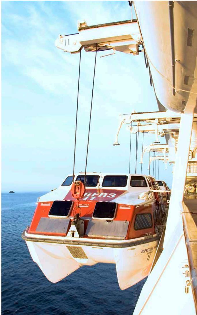
ボート滑車は、ブロックと滑車の力の拡大率を利用することで、重い荷物を楽に吊り上げることができます。滑車装置を変えることで、必要な力の量はさらに小さくなります。全体の力の量は、滑車装置の変更によって変化します。
